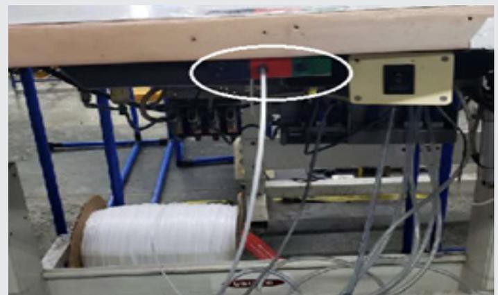
Figura 11. Guía welt instalada en máquina de zipper
